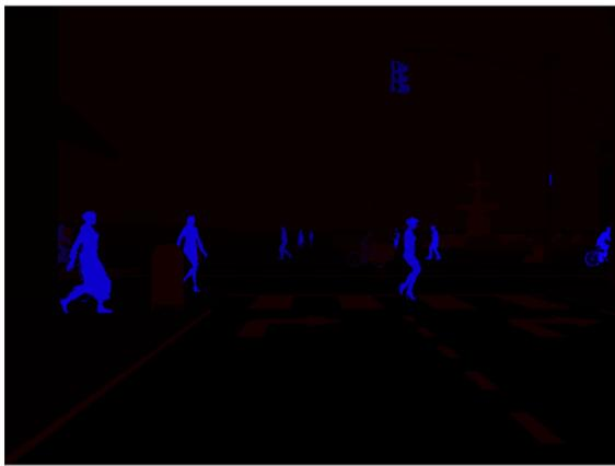
FIGURE 4.9 – Image segmentée des objets dynamiques
