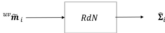
FIGURE 4.2 – Fonctionnement du système souhaité où à chaque point {}^{uv}\tilde{\mathbf{m}}_i est associé une matrice de covariance prédite \hat{\Sigma}_i par un réseau de neurones (RdN)
