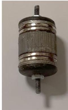
Figure III.13 – Photo de la masse mobile dont le bloc central ferromagnétique est feuilleté longitudinalement.
