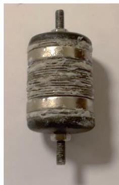
Figure III.28 – Photo de la masse mobile employée dans le prototype n°3. Le bloc central ferromagnétique est feuilleté dans le sens de l'axe  $x$  de déplacement.
