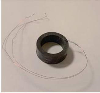
Figure III.11 – Photo de la bobine sur son support en plastique et protégée par un ruban adhésif.
