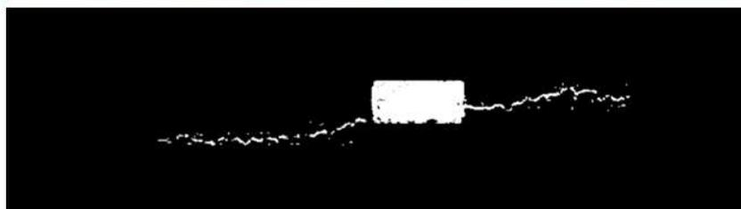
FIGURE C.2: Binarisation de l'image et isolement de fissure
