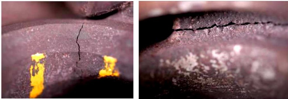
(a) Fissure détectée au niveau du siège de soupape
