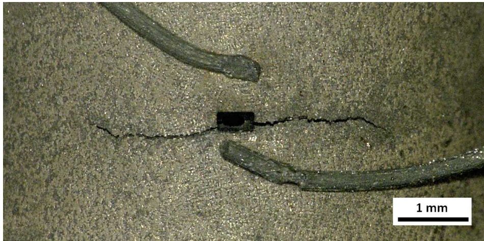
FIGURE 5.40: Essai N°12 TMF pour 300 °C - 800 °C, R_\epsilon = -\infty et \Delta\epsilon_m = 0.4\% : fissure ouverte en traction à la température minimale 300 °C
