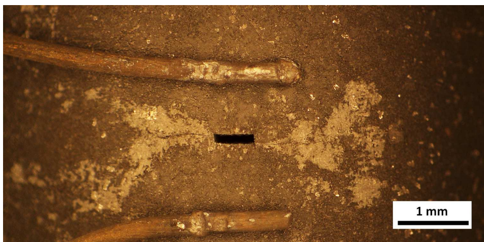
(b) Fissure fermée en compression à la température maximale 950 °C
