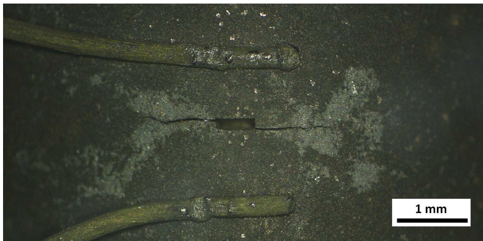
(a) Fissure ouverte en traction à la température minimale 300 °C
