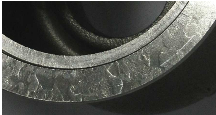
FIGURE 2.22: Observation macrographique des grains sur la surface usinée du carter turbine.
