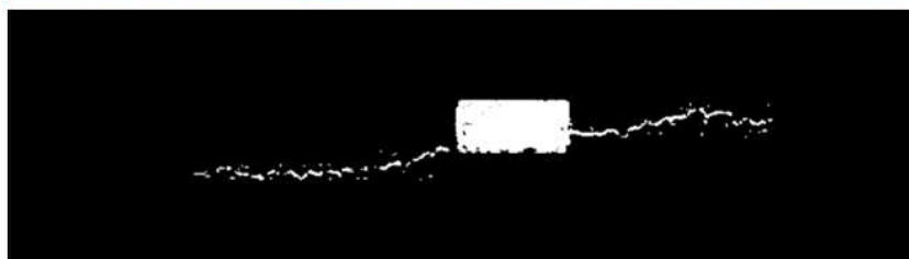
FIGURE C.2: Binarisation de l'image et isolement de fissure
