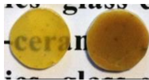
Figure I-26 : Vitrocéramiques de \text{TeO}_2 obtenues par frittage SPS à partir d'une poudre de verre de composition 85\text{TeO}_2-15\text{WO}_3 (%mol). Essais réalisés sur une poudre grossière, compactée et pré-frittée à 350^\circ\text{C} et avec utilisation d'une barrière thermique d'alumine lors du frittage [61].
