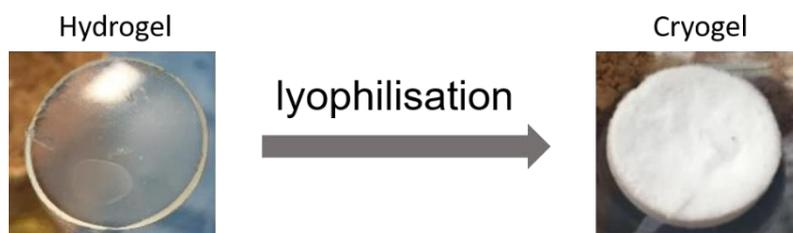
**Figure II-2 :** Hydrogel transformé en cryogel par lyophilisation (-90 °C, 0,06 mbar).
