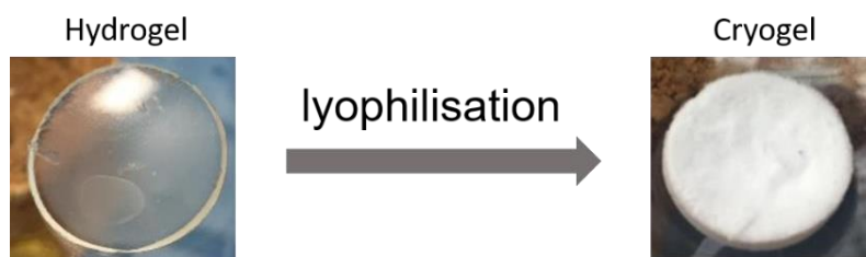
Figure II-2 : Hydrogel transformé en cryogel par lyophilisation ( -90\text{ }^{\circ}\text{C} , 0,06\text{ mbar} ).
