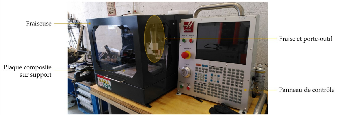
Figure II.6 : Fraiseuse de bureau Haas utilisée pour la découpe des composites tissés.
