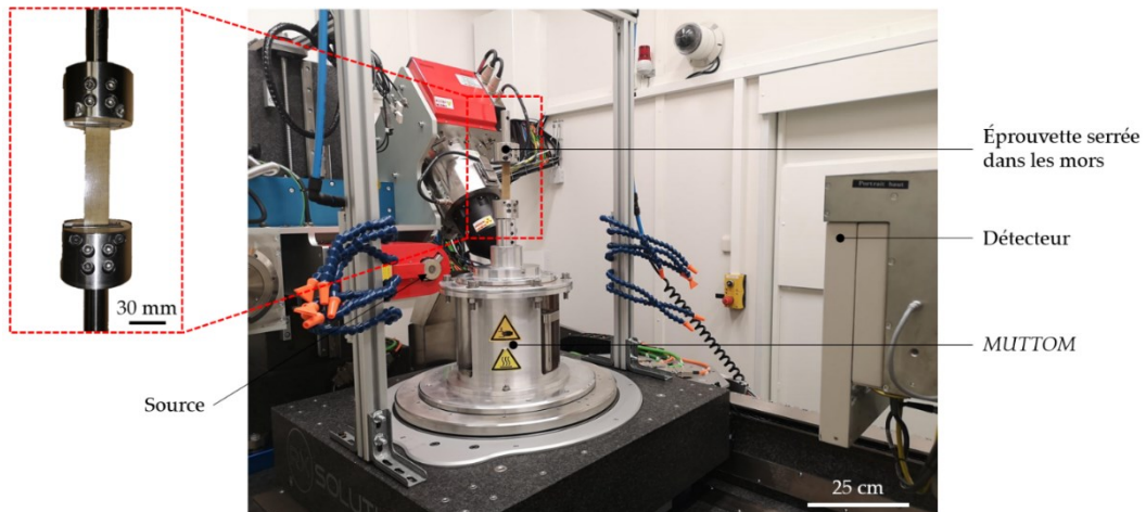
Figure II.30 : Montage d'une éprouvette de composite tissé dans la machine de traction MUTTOM installée dans le microtomographe.
