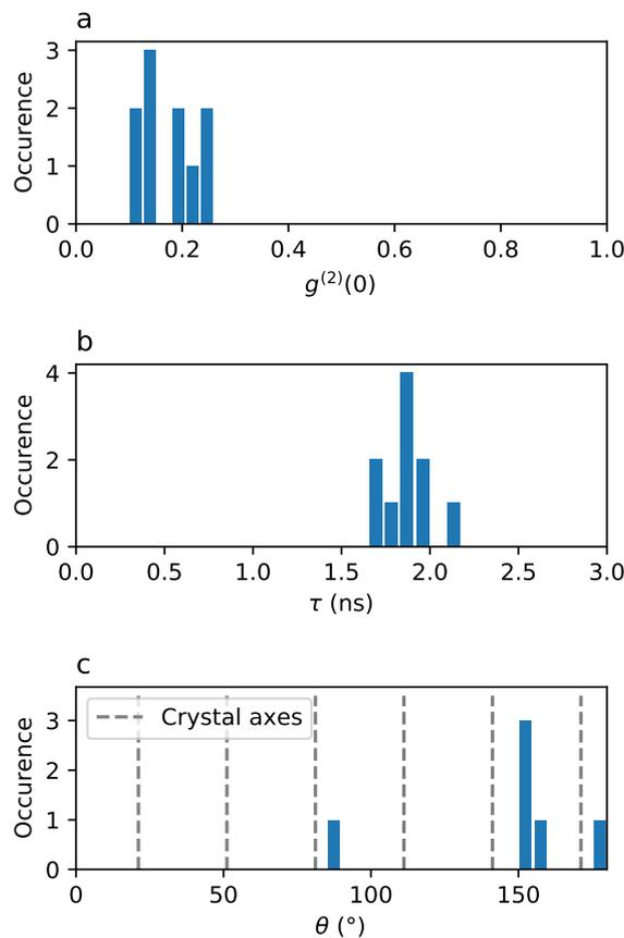
FIGURE 3.8 – Dispersion statistique des propriétés de différents émetteurs individuels à température ambiante. a)  $g^{(2)}(0)$  de 10 émetteurs, montrant tous sans ambiguïté une émission quantique. b) Temps de vie des mêmes 10 émetteurs. La valeur moyenne est de 1,87 ns. c) Axe de polarisation des photons émis provenant de 6 émetteurs d'un même *flake*.
