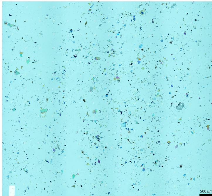
FIGURE 2.1 – Image au microscope optique d'un échantillon typique où du hBN a été exfolié sur substrat silicium. Chaque morceau coloré est un *flake*.
