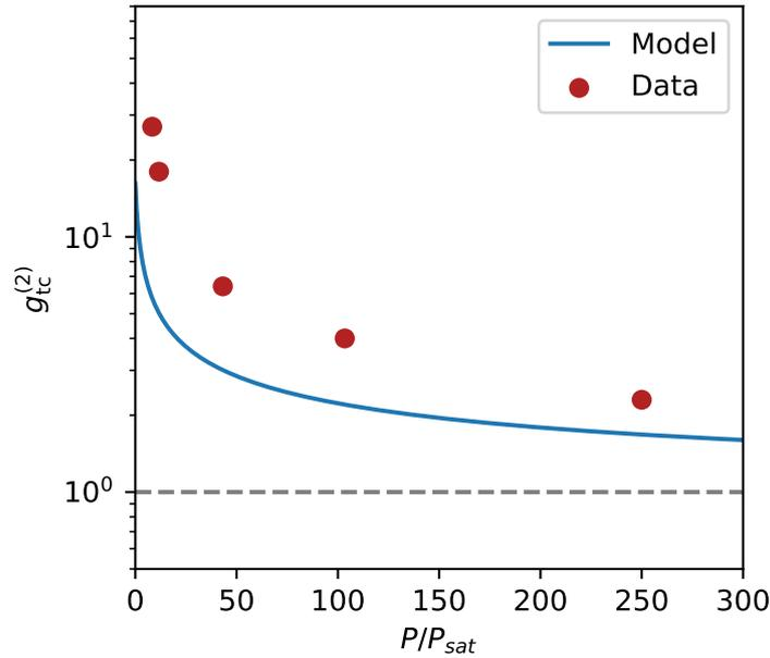
FIGURE 4.8 – Points rouges : valeurs expérimentales de  $g_{tc}^{(2)}$  en fonction de la puissance du laser. Courbe bleue :  $g_{tc}^{(2)}$  en fonction de la puissance du laser calculé en utilisant l'équation 4.8 . Ligne pointillée : asymptote lorsque  $P \rightarrow \infty$  :  $g_{tc}^{(2)} = 1$ .
