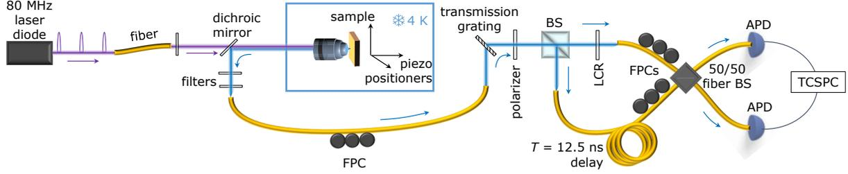
FIGURE 5.2 – Montage expérimental. FPC = Contrôleur de la polarisation de la fibre (*Fiber polarization controller*), BS = lame séparatrice (*beam splitter*), LCR = lame à retard à cristaux liquides (*Liquid-crystal retarder*), TCSPC = Carte de comptage (*Time-correlated single photon counter*).
