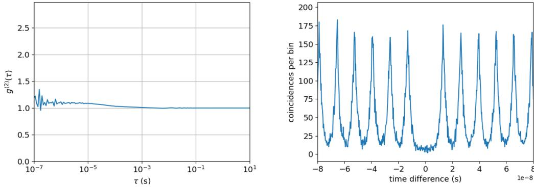
FIGURE 4.9 – Corrélations de photons en excitation résonante impulsionnelle. Gauche : Corrélations aux temps longs à  $3 \mu\text{W}$  où très peu de *bunching* est observé. Droite : Corrélations aux temps courts, où aucun pic au délai nul n'est observé.
