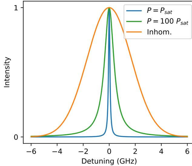
FIGURE 4.7 – Taux de comptage en fonction du désaccord laser-émetteur. Courbes bleue et verte : élargissement homogène pour  $P = P_{sat}$  et  $P = 100 P_{sat}$  respectivement, simulées en utilisant l'équation 4.1. Courbe orange : élargissement inhomogène décrit par l'équation 4.2, correspondant à une gaussienne de largeur 4 GHz (largeur mesurée sur les scans résonants figure 4.3).
