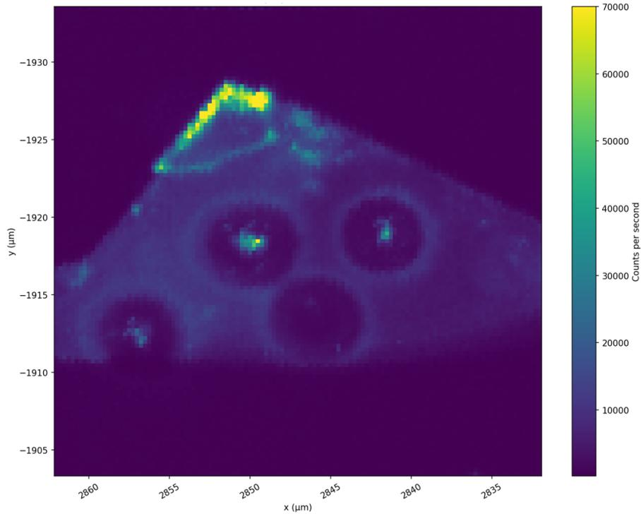
FIGURE 2.4 – Carte confocale à température ambiante d’un *flake* de hBN sur substrat silicium provenant du même échantillon que celui montré en figure 2.1. Le *flake* a été irradié à 4 positions créant des centres colorés émettant de la PL. La PL est filtrée avec un filtre passe-bande centré à 434 nm, de largeur 17 nm.
