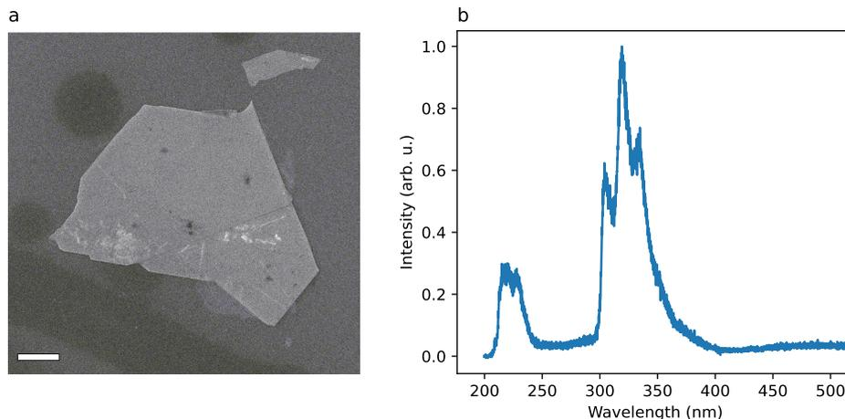
FIGURE 3.10 – a) Image MEB du *flake* de hBN avant irradiation. La barre blanche représente  $10 \mu\text{m}$ . b) Spectre de cathodoluminescence du *flake* avant irradiation réalisé avec une tension d'accélération de 1 kV.
