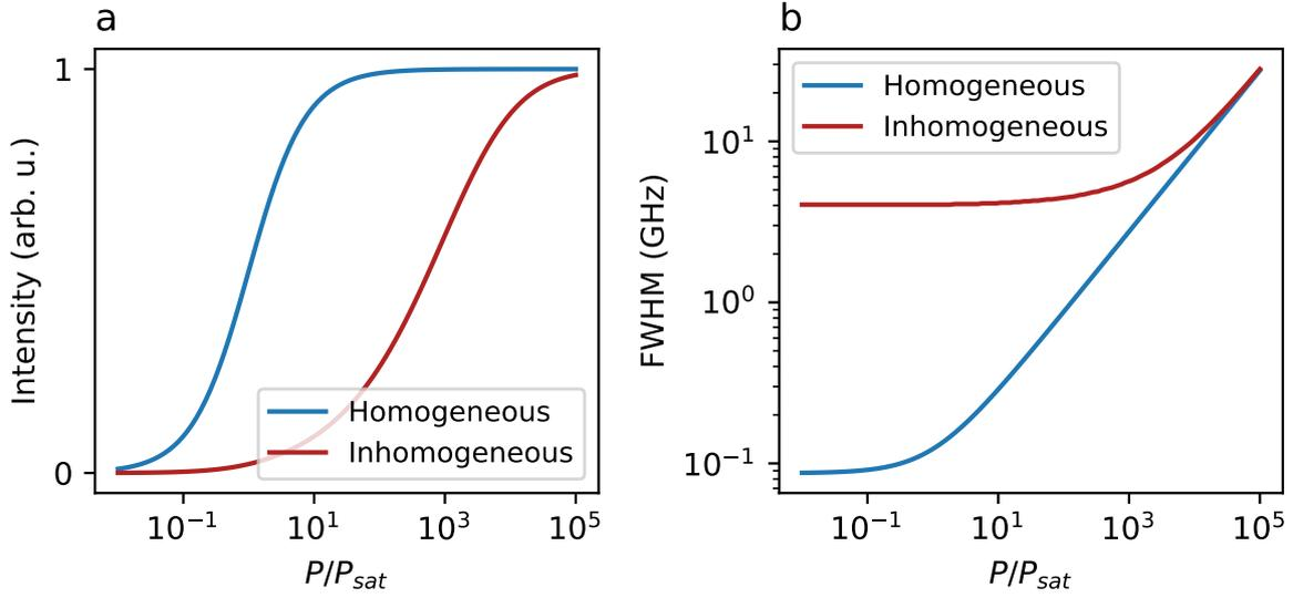
FIGURE 4.4 – Simulations réalisées par Aymeric Delteil.  $T_2$  est pris égal à  $2T_1$ . a) Taux de comptage en fonction du paramètre de saturation  $P/P_{\text{sat}}$ , calculé dans le cas homogène (courbe bleue) et inhomogène (courbe rouge). b) Largeur à mi-hauteur des scans résonants, calculée dans le cas homogène (courbe bleue) et inhomogène (courbe rouge).
