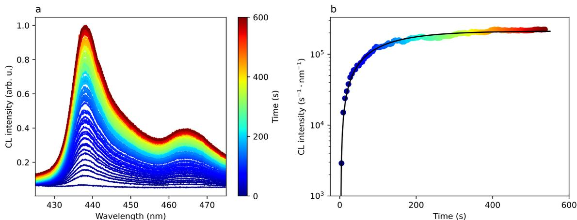
FIGURE 3.11 – a) Accumulation de spectres de cathodoluminescence pendant la durée de l'irradiation (15 kV, 9 nA, diamètre =  $1 \mu\text{m}$ , 10 minutes). Chaque spectre correspond à un temps d'intégration de 3 s. Un filtre passe-haut est utilisé pour éliminer la diffraction au second ordre de la luminescence de l'exciton. b) Points : intensité du pic à 440 nm sur les spectres de CL en fonction du temps. Ligne : ajustement des données en utilisant l'équation 3.3.
