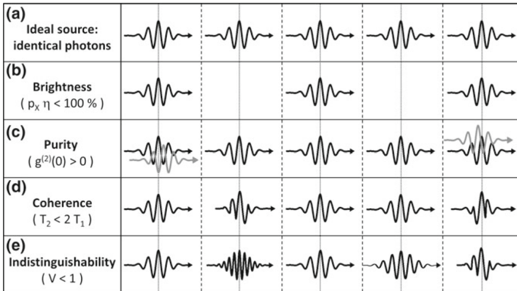
FIGURE 1.5 – a) Source idéale : un flux de photons uniques et identiques est généré par excitation laser impulsionnelle. b) Exemple d’une source avec une brillance inférieure à 1. L’émission d’un photon a lieu seulement pour certaines impulsions laser. c) Pureté imparfaite : deux photons sont parfois émis lors de la même impulsion laser. d) Perte de cohérence du photon schématisée par des lignes discontinues. e) Indiscernabilité imparfaite : le paquet d’onde du photon change à cause de variations de phase ou de diffusion spectrale. Figure tirée de [11].
