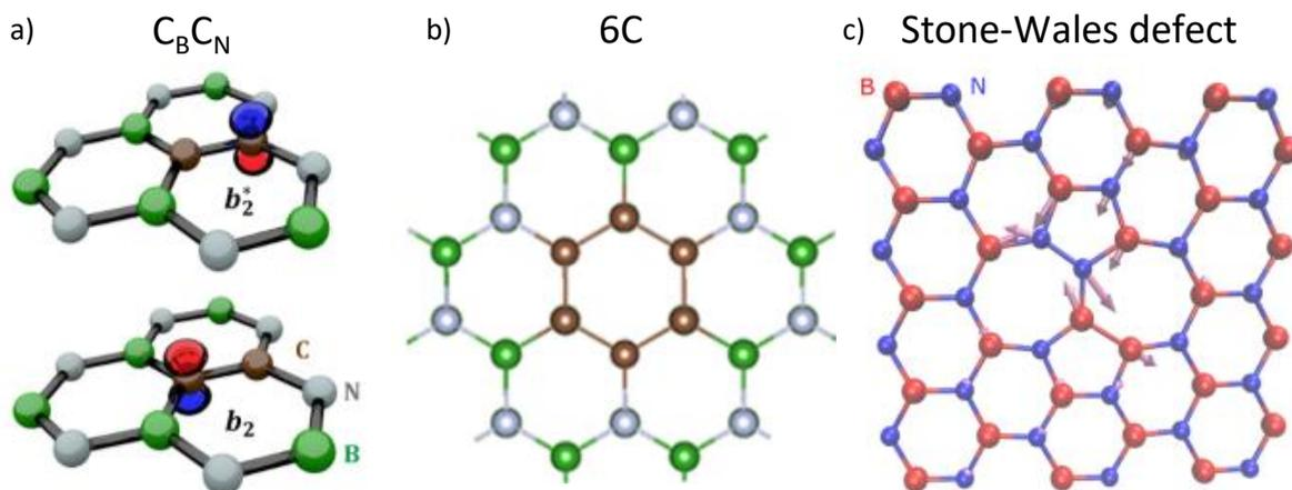
FIGURE 3.18 – a) Figure tirée de [18] représentant le dimère de carbone  $C_B C_N$ . b) Figure tirée de [19] représentant l'anneau de carbone 6C. c) Figure tirée de [21] représentant un défaut de Stone-Wales avec deux heptagones et pentagones au lieu d'hexagones.
