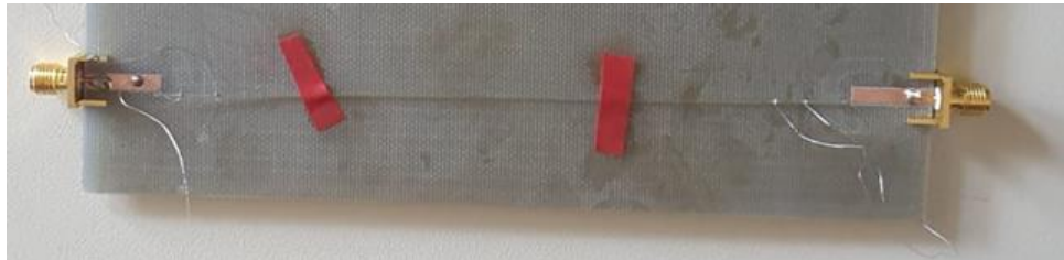
Figure 95 : La fibre connectée par l'une de ses extrémités (gauche), à travers les extensions des deux électrodes, jusqu'à la ligne de charge d'une ligne microruban, ainsi qu'à l'une des masses du connecteur SMA. L'autre extrémité de la fibre est laissée libre.
