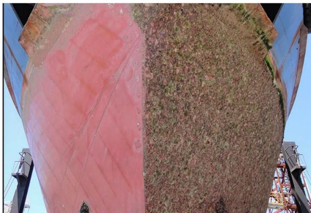
Figure 13 : Exemple d'une surface après biofouling à droite et avant à gauche (extrait de [114]).
