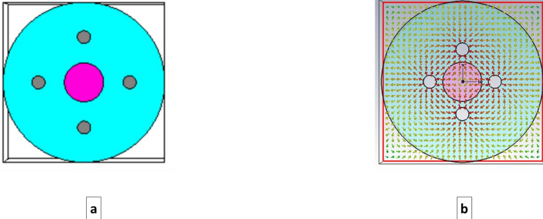
Figure 85 : La fibre à quatre électrodes et à droite la distribution du champ à travers cette fibre.
