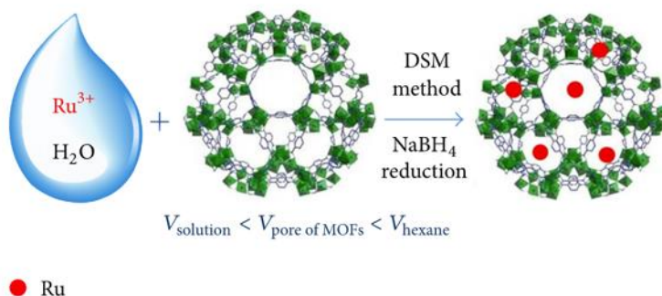
Figure 31 : Illustration du procédé d'incorporation de ruthénium dans le MIL-101(Cr) par la méthode des co-solvants et réduction du ruthénium (d'après Bie et al. ) [130]
