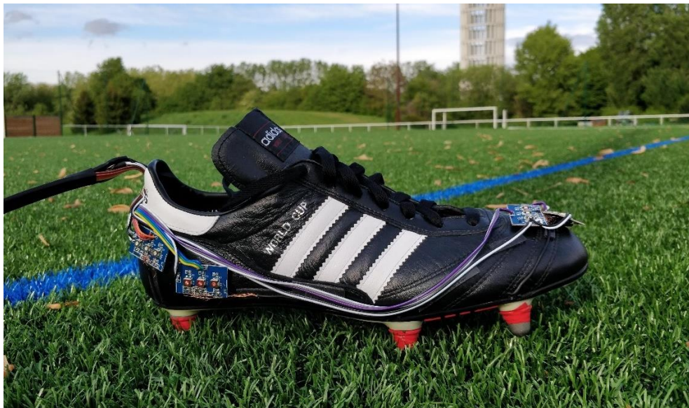
Figure 24 - Version 1.0 de la chaussure à CI (2019). Les câbles à l'arrière de la chaussure sont reliés à un boîtier d'acquisition externe.
