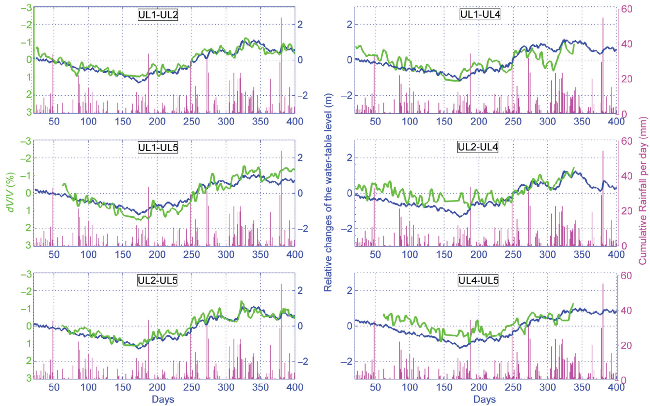
Fig. 1.7 Principaux résultats obtenus par Voisin et al. (2016) sur un glissement de terrain. Comparaison entre les variations relatives de vitesses mesurées sur les variations des ondes balistiques (onde de Rayleigh) et la mesure de pression des pores (bleu). L’histogramme violet représente la pluviométrie journalière.
