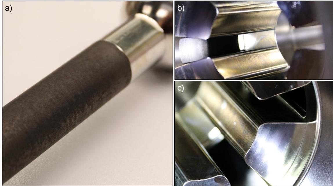
**Figure 3.21:** Photographies montrant : a) l'usure de la cathode pleine après plusieurs essais EM, b) côté gauche de l'anode et c) côté droit. Dans le cas b), les électrons ont moins coloré l'inox en comparaison avec le cas c) qui coïncide avec la partie la plus piquée de la cathode.
