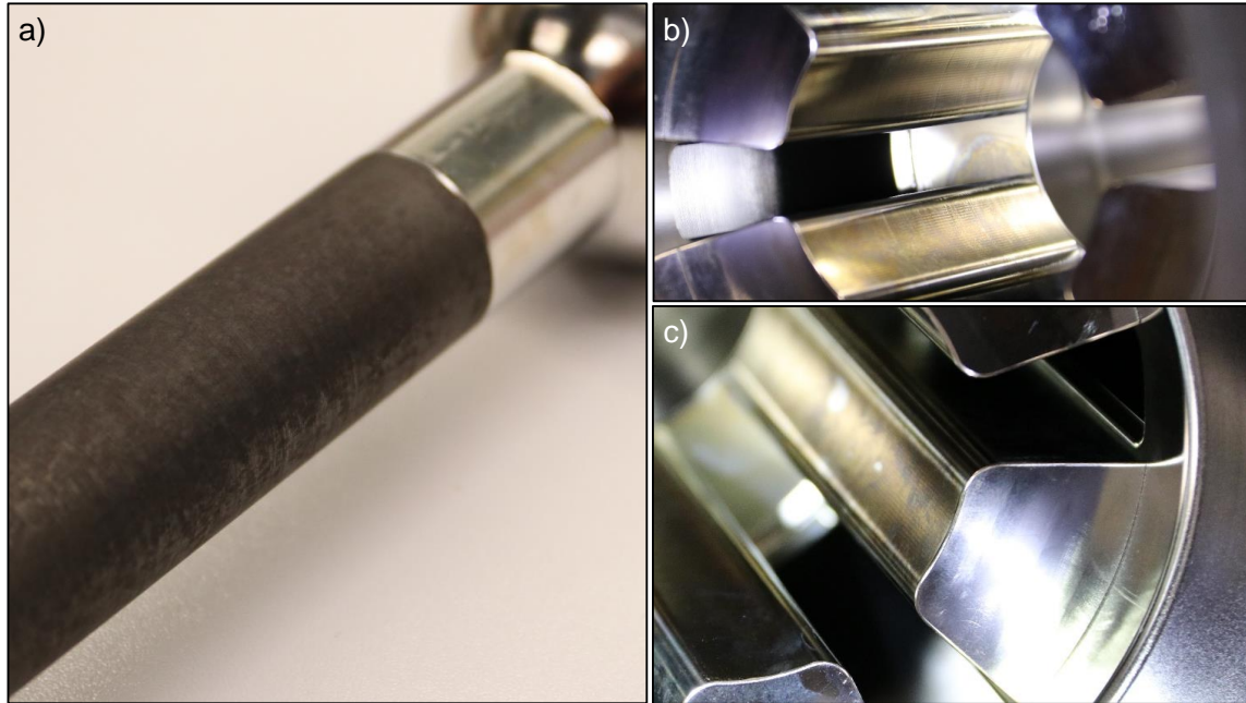
Figure 3.21: Photographies montrant : a) l'usure de la cathode pleine après plusieurs essais EM, b) côté gauche de l'anode et c) côté droit. Dans le cas b), les électrons ont moins coloré l'inox en comparaison avec le cas c) qui coïncide avec la partie la plus piquée de la cathode.
