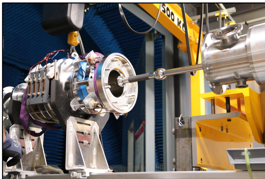
Figure 3.18: Photographie du montage de la cathode pleine de diamètre intermédiaire.
