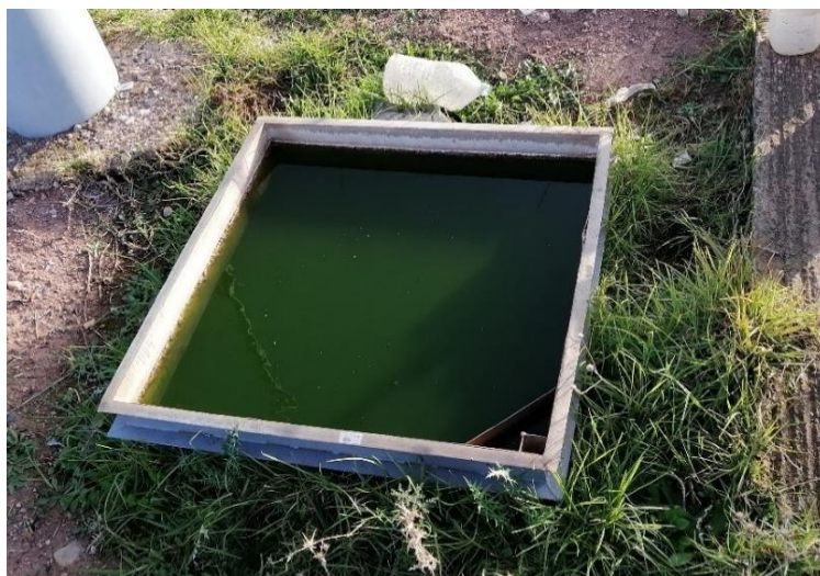
Photo 8-4 Bac d'évaporation à la station du b'AEH (El Orfi, 2020)
