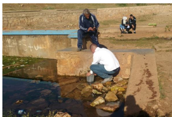
Photo 5-6 Mesure du débit de la source d'Assoul par un seau (Ghadbane, 2018)
