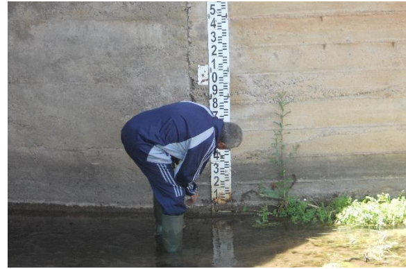
Photo 4-2 Lecture de l'échelle limnimétriques installée sur l'Oued Amngous (El Orfi, 2019)
