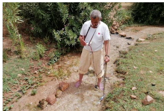
Photo 5-8 Mesure de débit de la source de Bou Ighzil par le micro-moulinet (El Orfi, 2020)
