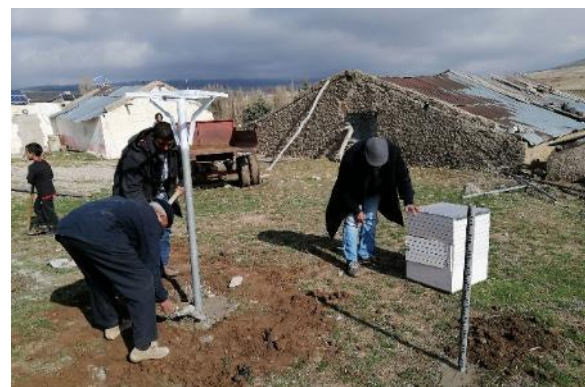
Annexe 3.19 Equipement du site de Tamchachat par les instruments de mesure des principales propriétés de la neige (El Orfi, 2019)
