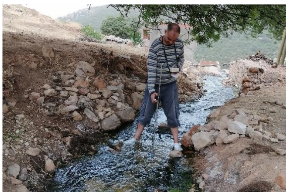
Photo 5-7 Mesure de débit de la source de Tiguelmamine par le micro-moulinet (El Khidar, 2020)
