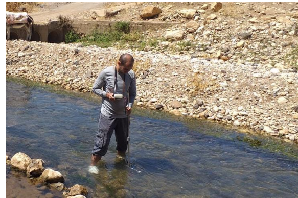
Photo 4-4 Mesure du débit de l'amont de l'Oued Fellat (El Orfi, 2019)
