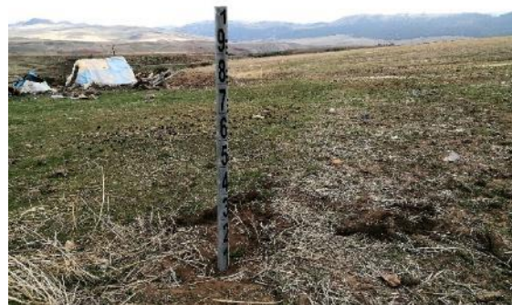
Annexe 3.19 Equipement du site de Tamchachat par les instruments de mesure des principales propriétés de la neige (El Orfi, 2019)
