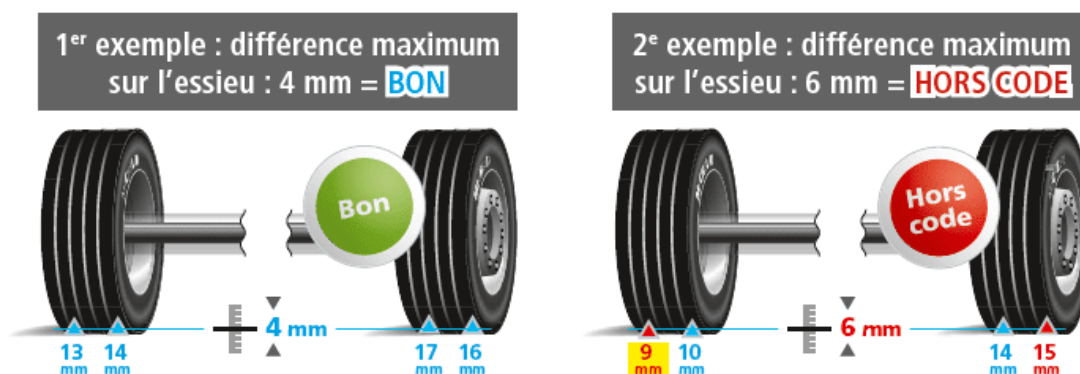
Figure V-21 : La profondeur des sculptures sur un même essieu
