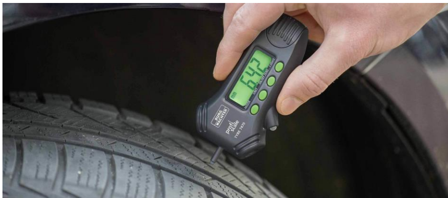
Figure V-4: Exemple de jauge d'usure pour pneus
