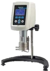
Figure 31 : Viscosimètre à géométrie cône/plan
