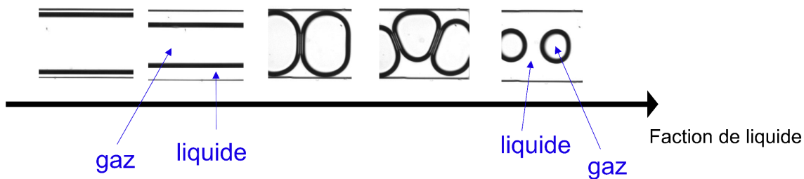
FIGURE 2.1 – Formation de bulles de différentes tailles ou de jets, selon les paramètres d'injection.
