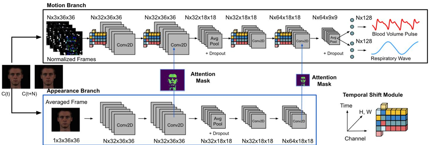
FIGURE 4.4 – L'architecture du réseau MTTS-CAN [368].
