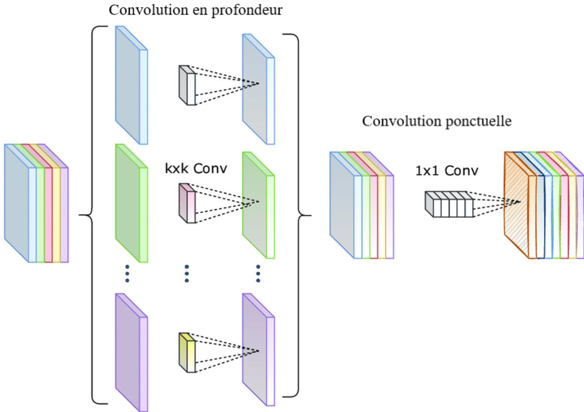
FIGURE 3.6 – Schéma de la convolution séparable en profondeur.
