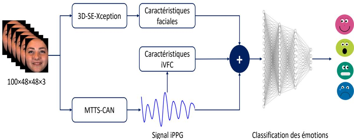
FIGURE 4.8 – Système proposé pour la reconnaissance multimodale des émotions basé sur les expressions faciales, signal iPPG et les caractéristiques de la VFC.
