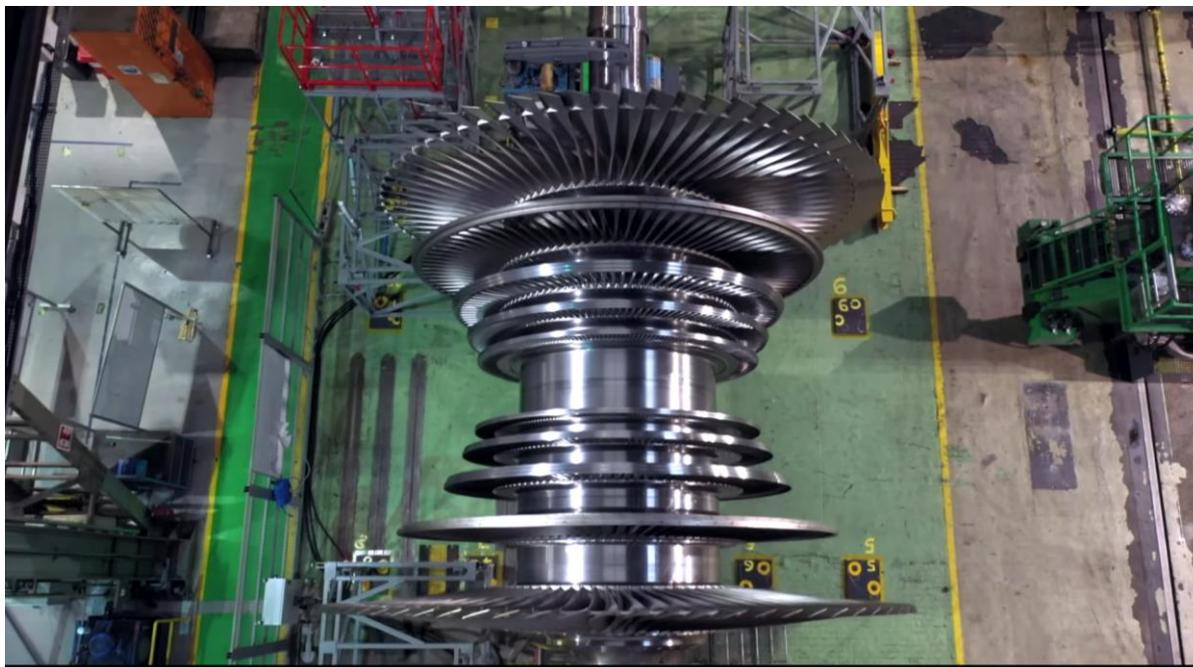
Figure F-6. Corps basse pression d'une turbine Arabelle en construction [132]
