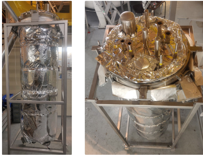
FIGURE 3.16. Nouvelle cuve du bain d'HELIOS.
