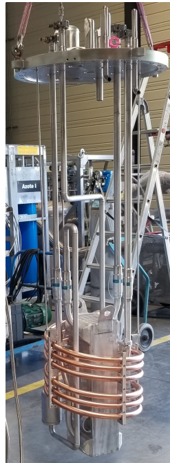
FIGURE 3.14. Vue du bloc échangeur et du pré-échangeur de la nouvelle boucle HELIOS.
