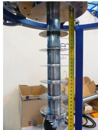
**FIGURE 2.15.** Écrans thermiques du circulateur.
