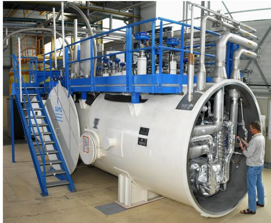
FIGURE 2.3. Boîte froide de la station 400W.
