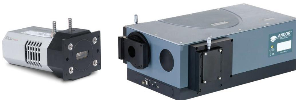
Figure 2.5 Spectromètre UV-Visible Shamrock Czerny-Turner relié avec une caméra CCD.
