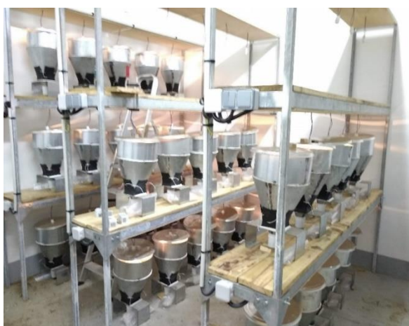
Figure 20 : L'extraction de la faune du sol par la méthode Tullgren-Berlèse
