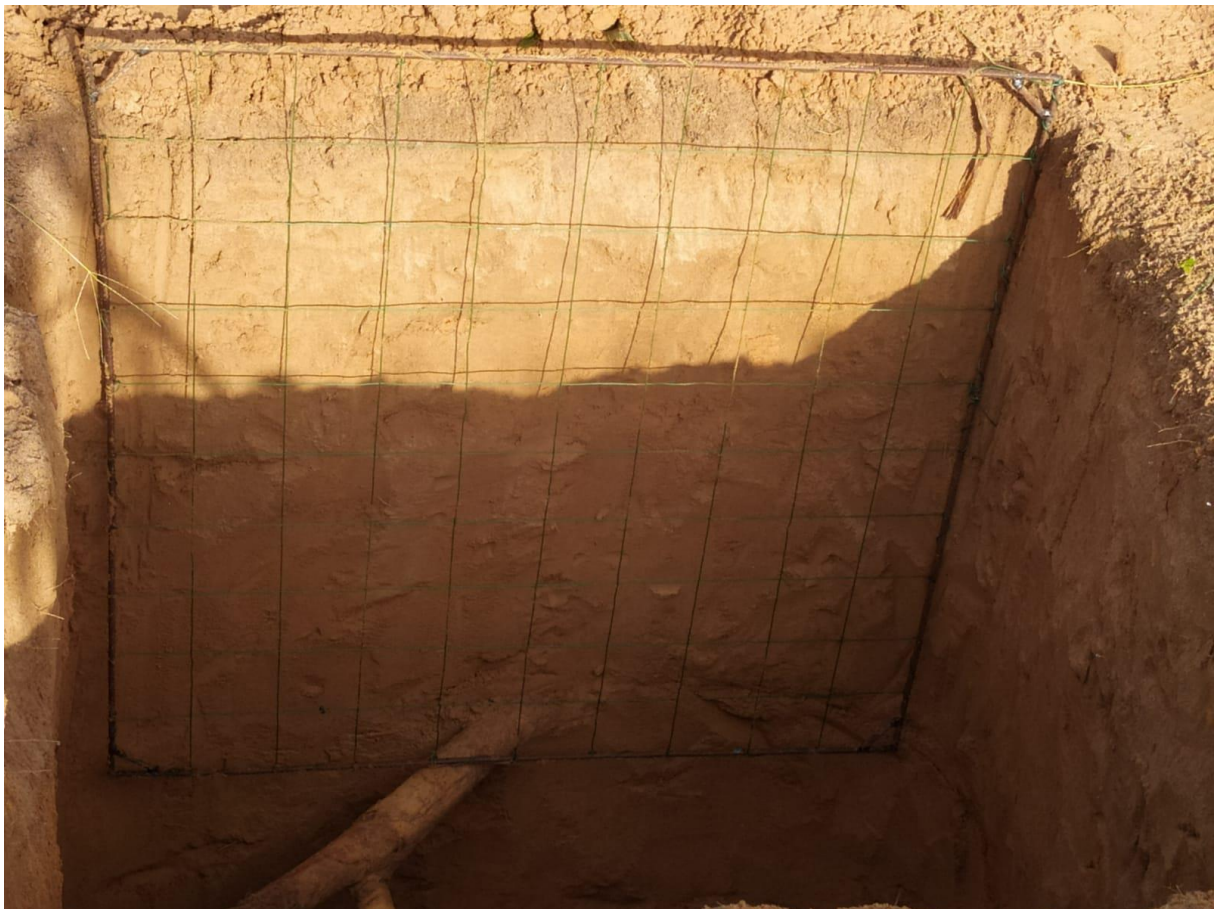
Fig. II-4 Photographie d'un profil de sol sur le site Faidherbia-Flux jusqu'à 150 cm de profondeur. Chaque carré de la grille fait 10 cm 2 .
