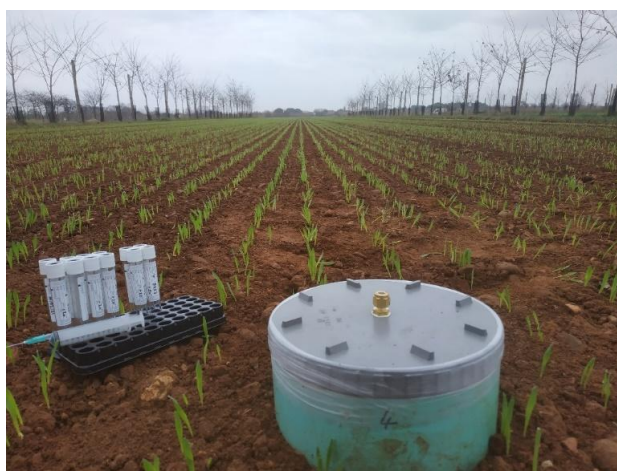
Fig. G-1 Dispositif expérimental de prélèvement d'échantillons de gaz à la seringue dans une chambre hermétique sur le site DIAMS dans le but de mesurer la concentration en N 2 O au cours de l'accumulation du gaz dans la chambre et calculer un flux d'émission.
