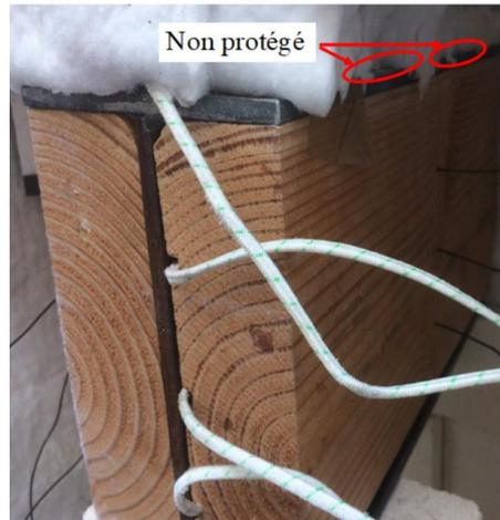
Figure 152: Mise en évidence d'un défaut d'isolation au niveau de l'isolation de la semelle supérieure
