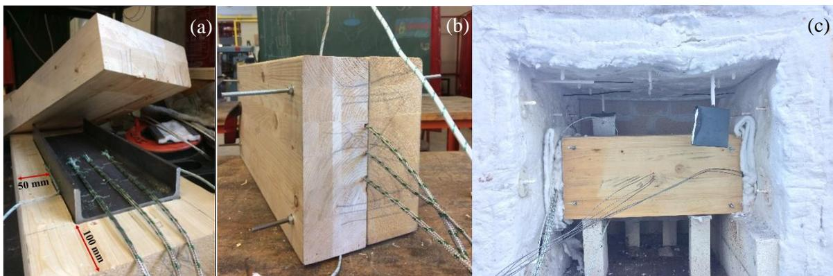
Figure 85: Test n°8 – Mise en place de la poutre mixte IPE 140 – BLC
