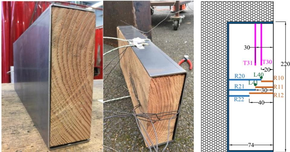
**Figure 107 : Epreuve bois et profilé acier en U et thermocouples à différentes profondeurs dans le bois (Test n°13)**
