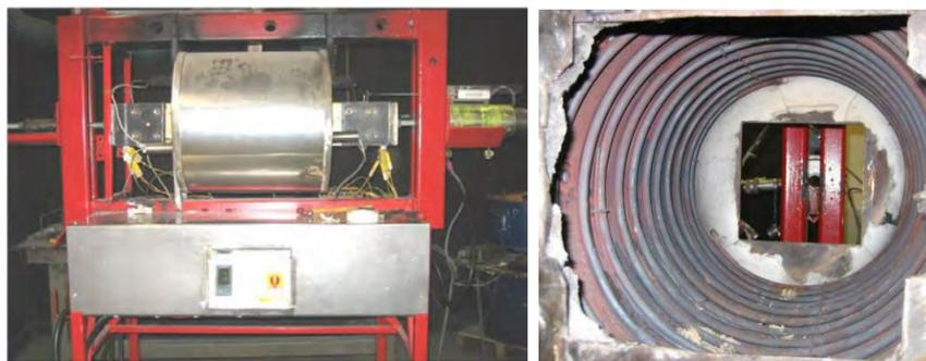
*Figure 134 : Échantillon dans le four avant le test et système chauffant électrique [147]*
