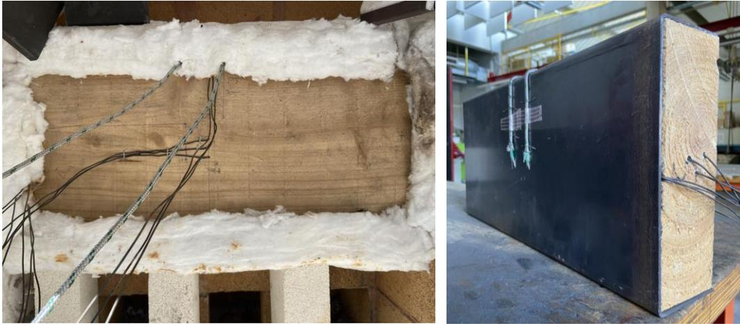
*Figure 114: Préparation de l'éprouvette bois-acier avec thermocouples à différentes profondeurs dans le bois (Test n°14)*
