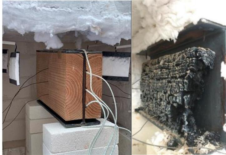
**Figure 71: Test n°3 - Installation de la poutre avant de placer l'isolant sur la semelle supérieure et après le test**
