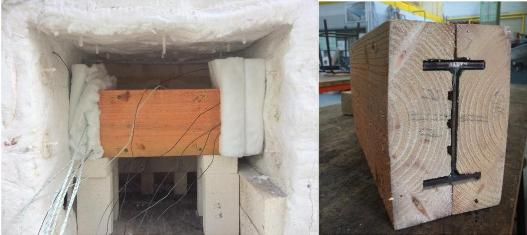
Figure 144 : Mise en place de l'échantillon dans le four et vue de la section totalement enrobée
