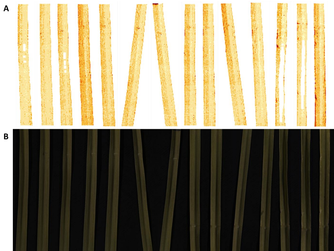
Figure 27 : (A) 34_G_1 EPO_67 « Mock » Heatmap en zones (6 zones avec en haut la zone proximale (6) et en bas la zone distale (1)) (B) Images RGB de 34_G_1 en miroir par rapport aux heatmaps et en fausses couleurs issues de la caméra VNIR. Les groupes de valeurs de T^2 sont répartis ainsi : (i) de 0 à 0.75 ; (ii) de 0.75 à 1 ; (iii) de 1 à 1.25 ; (iv) de 1.25 à 2 ; (v) de 2 à 6 (groupes représentant la queue lourde de la distribution) ; (vi) de 6 à 15 (groupes représentant la queue lourde de la distribution)
