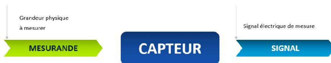
FIGURE 2.11 – Principe de fonctionnement d'un capteur.
