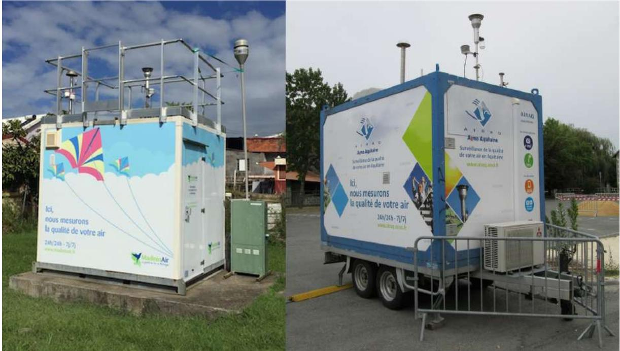
FIGURE 2.7 – Photographies d'une station fixe et d'une station mobile du réseau ATMO [36].
