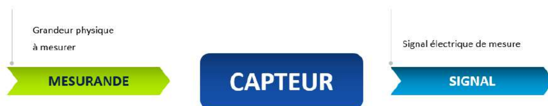
FIGURE 2.11 – Principe de fonctionnement d'un capteur.
