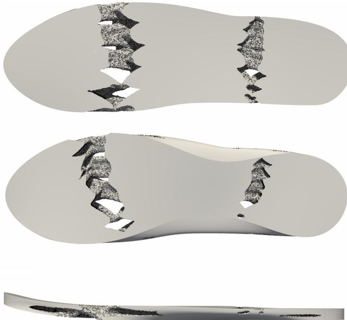
FIGURE VII.5.18 – Design optimisé d'une semelle viscoélastique en vibration pour la maximisation du décrétement logarithmique à volume constant, sous contrainte de compliance  $C_l = 0.75C_0$ .
