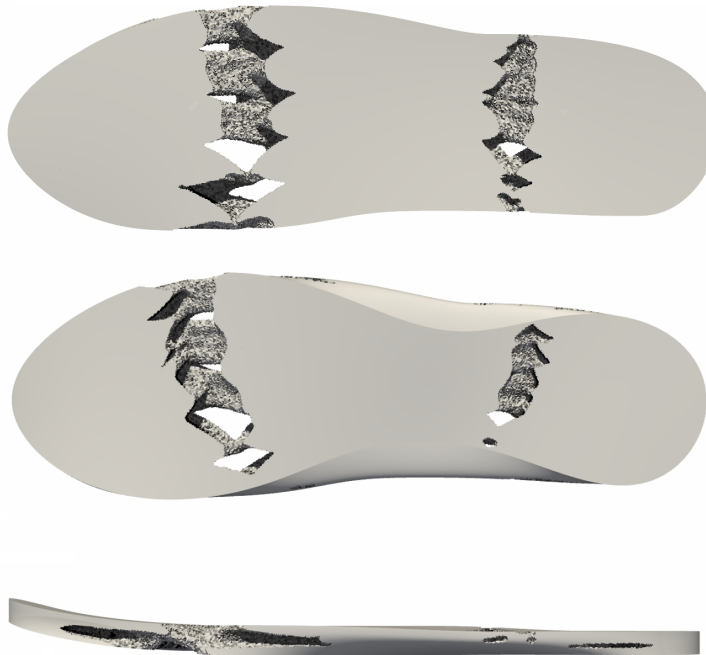
FIGURE VII.5.18 – Design optimisé d'une semelle viscoélastique en vibration pour la maximisation du décrétement logarithmique à volume constant, sous contrainte de compliance C_l = 0.75C_0 .
