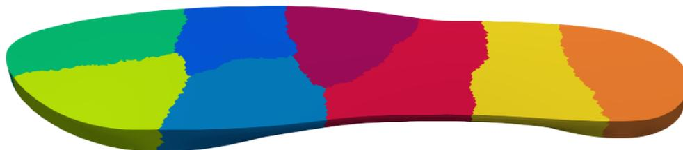
FIGURE VII.4.7 – Exemple de décomposition de domaine de la semelle de chaussure pour 8 processeurs.
