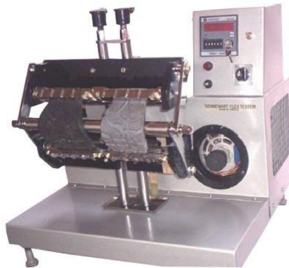
FIGURE VI.1.1 – Test de flexion Bennewart réalisé sur des semelles de chaussure de course.
