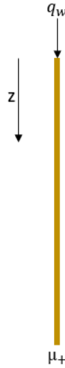
FIGURE 4.1 – Représentation schématique de la colonne de limon considérée avec une saturation initiale S_+ .
