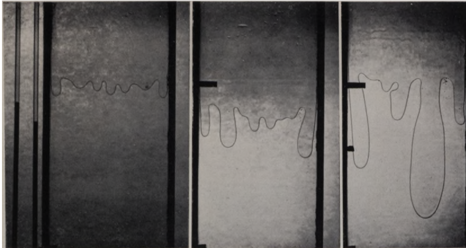
FIGURE 5 – Digitation visqueuse dans une cellule Hele-Shaw verticale où l’air déplace du glycérol du haut vers le bas (Saffman & Taylor 1958).
