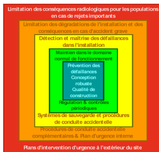
Figure 3 : Niveaux de défense en profondeur d'un réacteur et objectifs associés (source : www.irsn.fr ).
