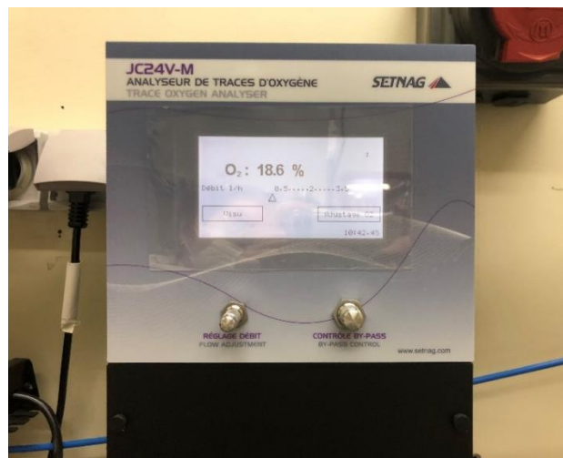
Figure II-15 : Oxymètre utilisé durant les essais VITOX en mode oxygène.
