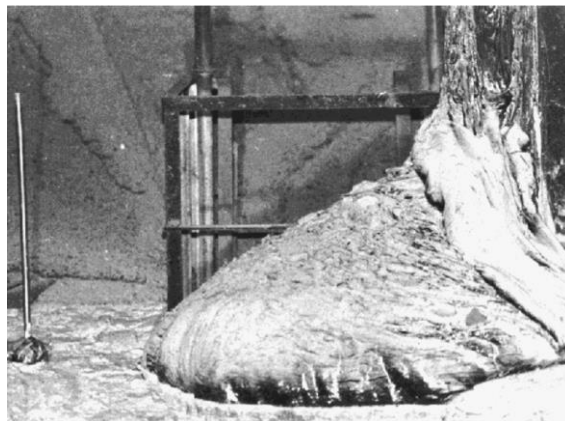
Figure I-3 : Coulée de corium connue sous le nom de pied d'éléphant [2].
