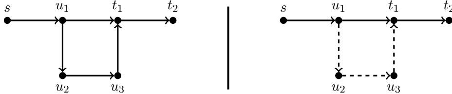
FIGURE 3.2 – Une instance du problème TM avec une source s et des sommets-cible t_1 et t_2 (à gauche) et une solution P (à droite). Les arcs appartenant à P sont représentés en continu.
