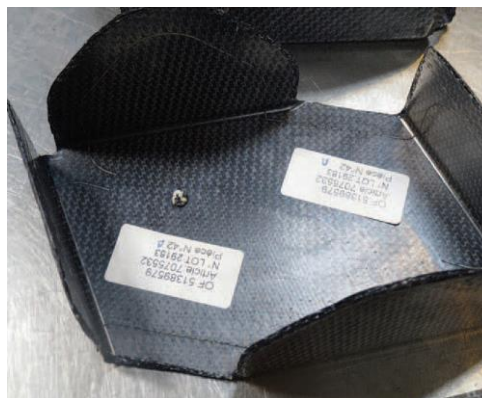
Figure 12 : Clip de fuselage d'A350 XWB produit par thermoformage-estampage par DAHER à Nantes [33].
