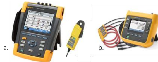
Figure 29 : Matériel de mesure électrique utilisé : a. Fluke 434 II avec pinces ampèremétriques Fluke i30s ; b. Fluke 1736 avec pinces ampèremétriques Fluke iFlex 1500-12.
