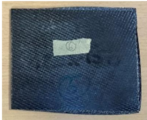
Figure 109 : Exemple de pièce plaque en C/PPS fabriquée par le procédé de thermoformage-estampage étudié.
