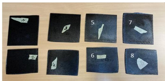
Figure 22 : Pièces fabriquées par thermoformage-estampage avec différentes configurations de paramètres.
