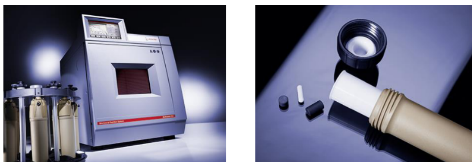
Figure A.I-3 : a) Four à micro-onde multimode Synthos 3000 et b) un des huit réacteurs 2
