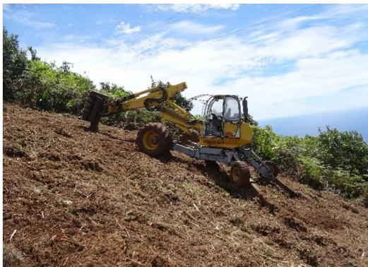
Figure 46 - Photographies de l'opération de lutte mécanique en cours à l'aide d'une pelle araignée par le titulaire du lot 1 (BIOTOPE, 2018-2020)
