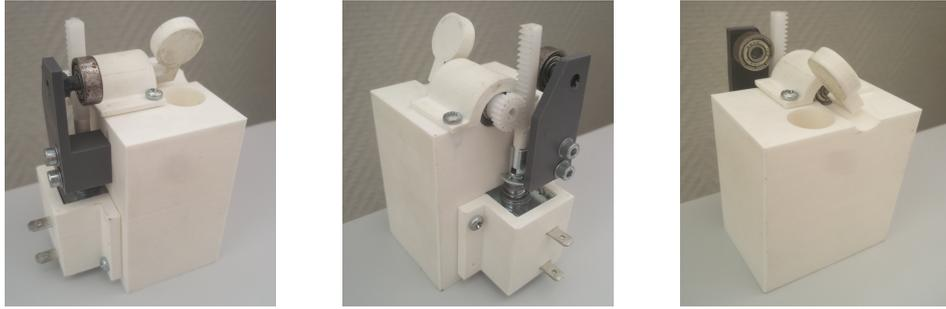
Figure 6.3 – Prototype de laboratoire du mécanisme de protection.
