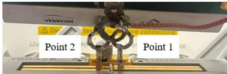
Figure III-5. Connexion des points 1 et 2 à l'analyseur d'impédance
