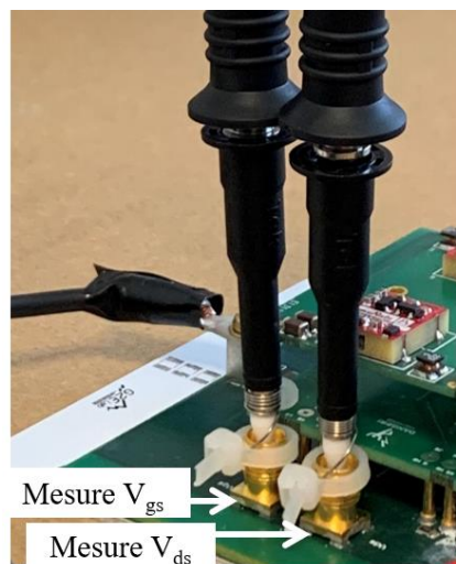
Figure III-31. Connexions des sondes de l'oscilloscope aux connecteurs SMA
