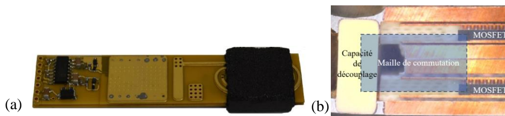
Figure I-41. Réalisation expérimentale (a) module complet (b) vue en coupe [81]
