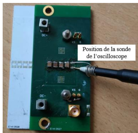
Figure III-25. Position de la sonde de l'oscilloscope
