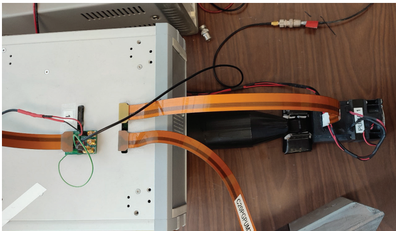
FIGURE 3.34 – Dispositif expérimental utilisé en laboratoire pour l'évaluation de la résolution en coïncidence temporelle (CTR) du système entre le signal externe du LaBr 3 et un module PUMA.
