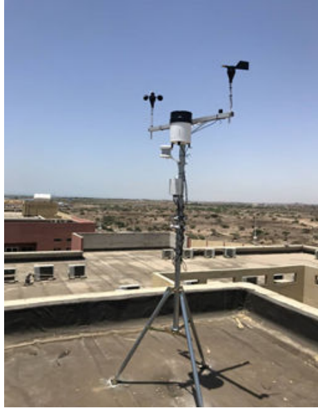
FIGURE 3.9 : Station météorologique HOBO installée à l'université de Djibouti depuis le 06 juin 2022.
