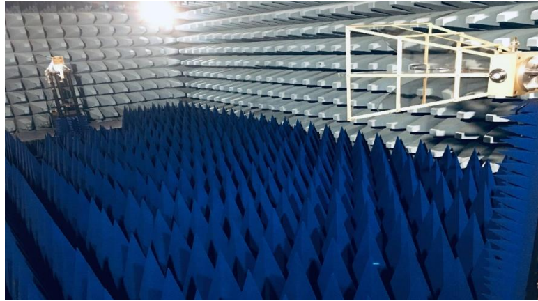
Figure 2. 17: Mesure de diagramme de rayonnement
