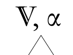
Figure 3.12 – Représentation schématique d'un "ressort-piston" fractionnaire. \mathbb{V} et \alpha sont ses paramètres constitutifs.
