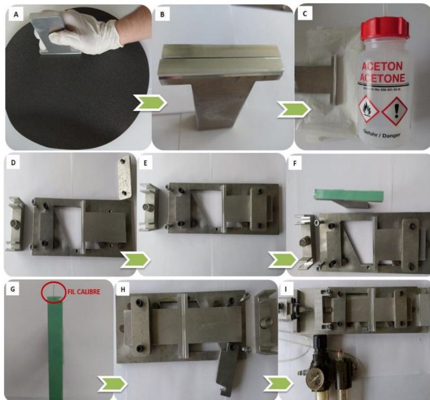
Figure 2.5 : Étapes de collage de l'éprouvette Scarf modifiée [55]
