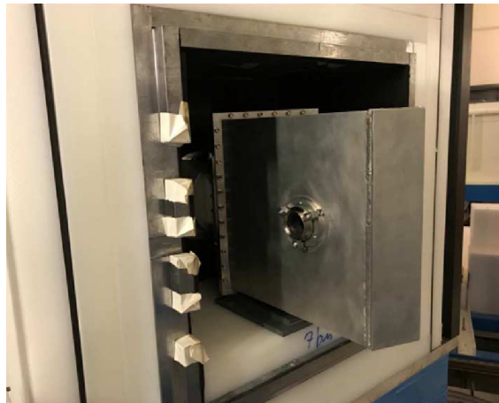
FIGURE 2.9 – À gauche : Photographie de la cible 30 kW. À droite : la chambre en aluminium, qui contient la cible qui est elle-même contenue dans le modérateur en polyéthylène et le blindage de la CANS 2022 (cf. section 3.5.2).
