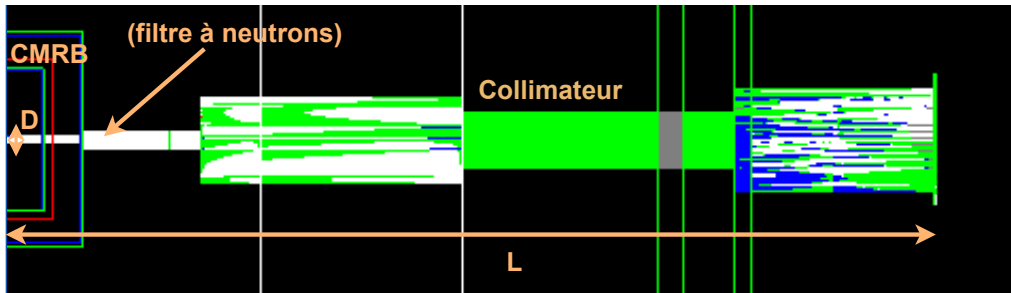
FIGURE 4.7 – Schéma du collimateur pour le transport des neutrons de gauche à droite, à partir du CMRB. La longueur L ainsi que le diamètre D en début du canal extracteur sont illustrés.
