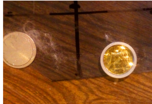
FIGURE 7.3 – À gauche : dosimètre or nu en place à la sortie du CMRB, au centre du canal extracteur. À droite : dosimètre or dans le boîtier cadmium.
