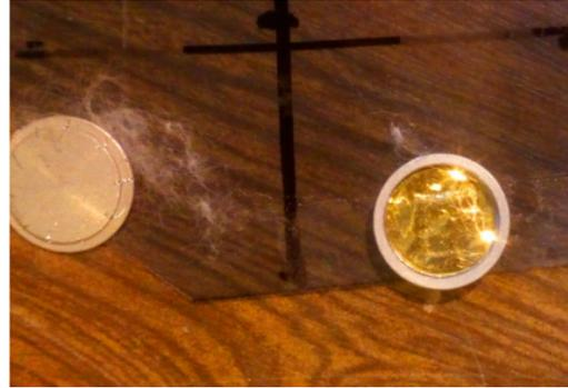
FIGURE 7.3 – À gauche : dosimètre or nu en place à la sortie du CMRB, au centre du canal extracteur. À droite : dosimètre or dans le boîtier cadmium.
