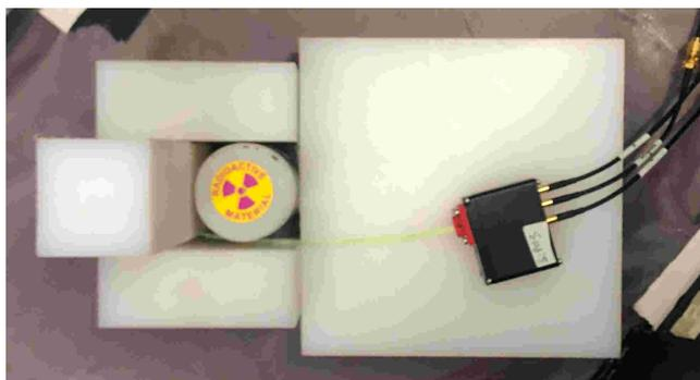
FIGURE 9.19 – Dispositif expérimental du SiPM reliés aux fibres.
