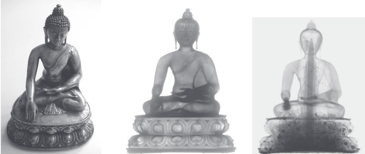
FIGURE 1.2 – De gauche à droite : Sculpture de bouddha imagée à l’œil nu, avec des RX et avec des neutrons thermiques [6].
